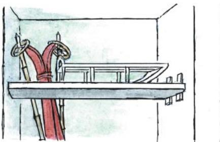
Чтобы установить полку между двумя бетонными стенами, в них необязательно сверлить отверстия. Достаточно забить между полкой и стеной несколько деревянных клиньев. Правда, сильно нагружать полку все же не стоит.
